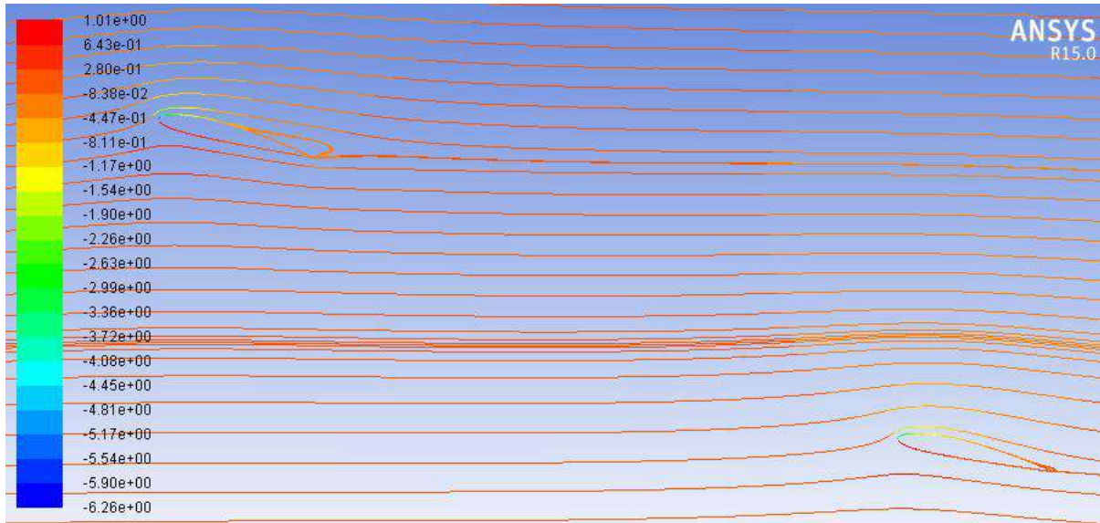
Рис.4.7. Продувка системи профілів аеродинамічної схеми «тандем» в програмному пакеті Ansys
