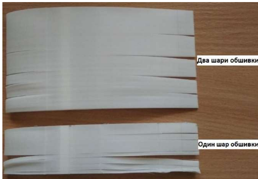
Рис.3.15. Розриви шарів в надрукованих зразках
