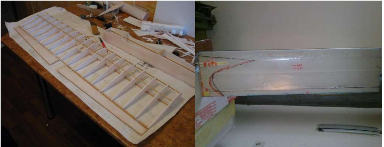
Рис.3.7. Композитне та набірне крило:
